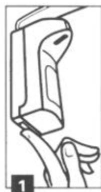
Zum Anheben der Haube Verriegelung lösen
