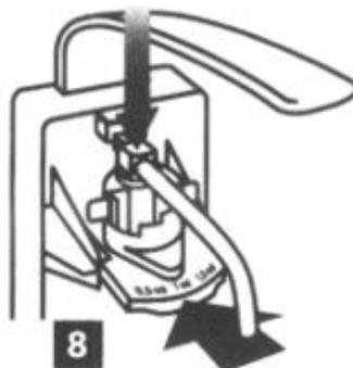
Zum Einsetzen Hebel hochhalten, gesamte Pumpeneinheit zurückziehen und zugleich den
